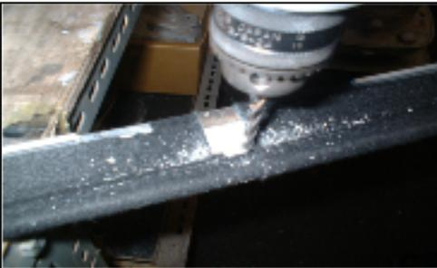
鉄鋸で縦に2箇所切込みを入れた後、ドリルで下部切断面に合わせて穴を開ける。
